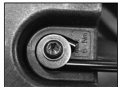
Torxschroef voor beschermrooster (aanhaalmoment 6Nm)
