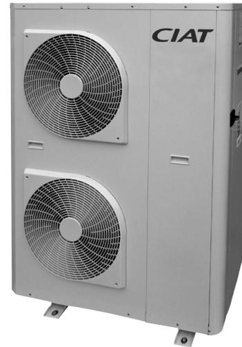
La frecuencia del compresor se incrementa de manera continua hasta el nivel máximo. Esto impide que se produzcan picos de consumo de corriente en la fase de arranque. La velocidad de aceleración del Inverter hace innecesario el arranque progresivo y garantiza una potencia máxima inmediata.
