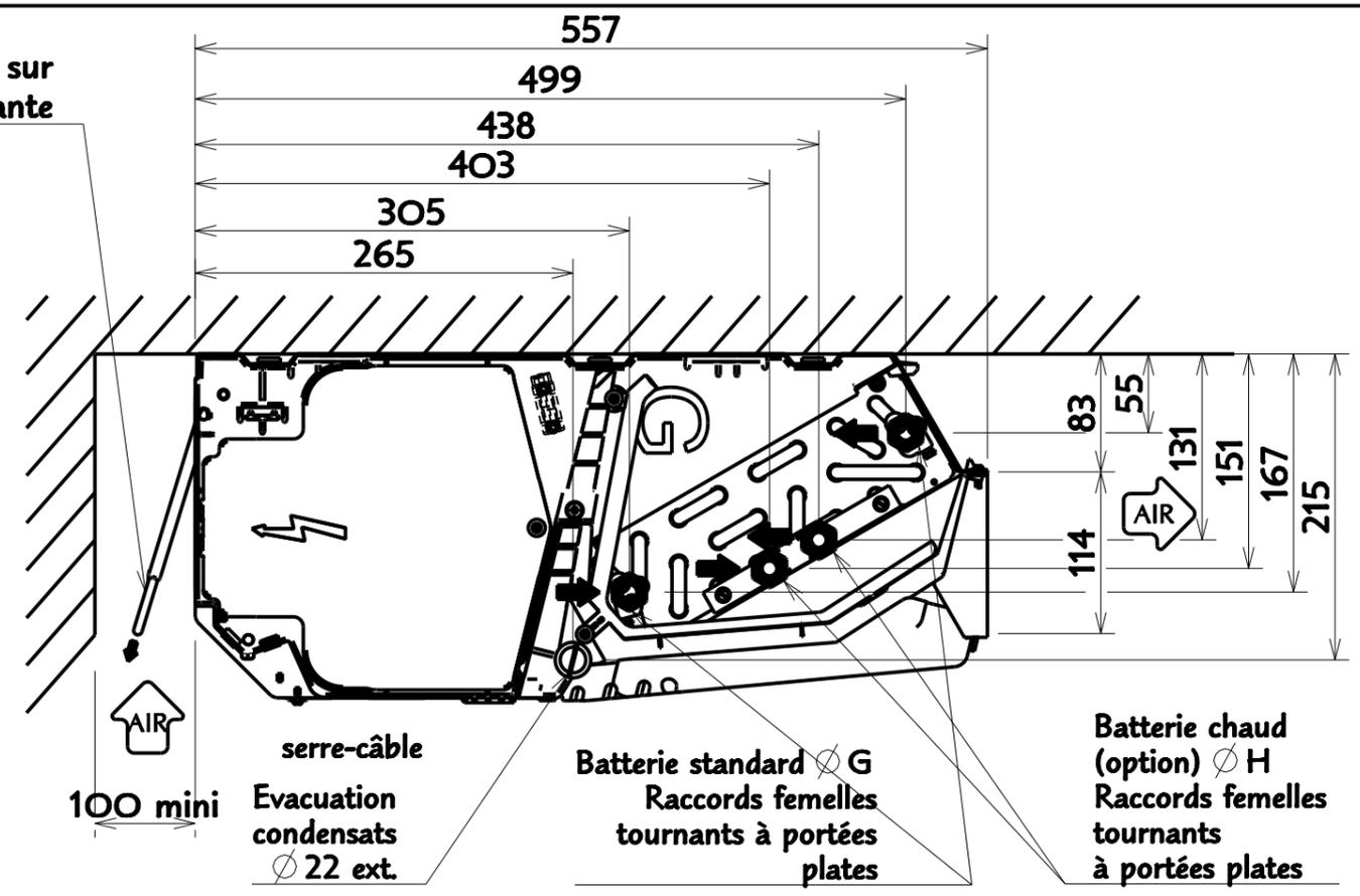
**Raccordements hydrauliques représentés pour batteries 2T ou 4TX . Pour batteries 4TY , voir folio 6**
