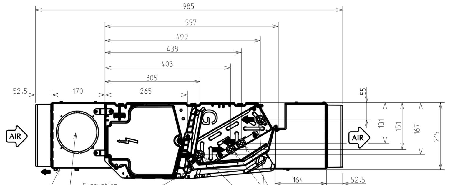
Panneau amovible permet d'accéder au filtre à air sur glissière pivotante
