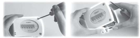
Pour configurer votre appareil, le mettre hors tension, procéder aux réglages souhaités en disposant les interrupteurs comme indiqué dans les tableaux. Une fois votre capteur configuré, le mettre sous tension
