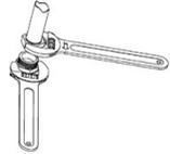
En el caso de que el equipo incluya válvulas de regulación preinstaladas, compruebe el apriete de las conexiones/válvulas antes y después de la conexión a la red eléctrica.
