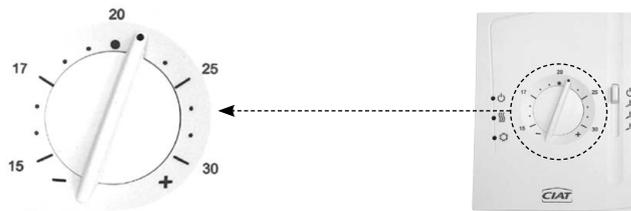
**!** Estos valores, destinados a ayudar a la comprensión del uso del potenciómetro, proporcionan simplemente una indicación de la T° elegida. Existirá una distancia más o menos importante entre el valor ajustado al potenciómetro y la temperatura real de la habitación, esto en función de las regulaciones elegidas (regulación posible de la zona neutra de 4/6°K, termostato que pida calor o frío).
