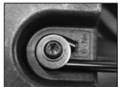
Torxschraube für das Schutzgitter (Anzugsdrehmoment 6 Nm)
