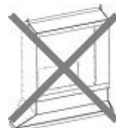
Ausblasdüse über einer Tür
