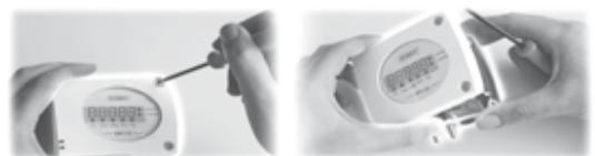
Bei der Konfiguration des Geräts darf es nicht unter Spannung stehen. Nehmen Sie die gewünschten Einstellungen vor, indem Sie die Schalter wie in den Abbildungen angezeigt setzen. Nachdem der Messfühler konfiguriert wurde, schließen Sie ihn ans Netz an.
