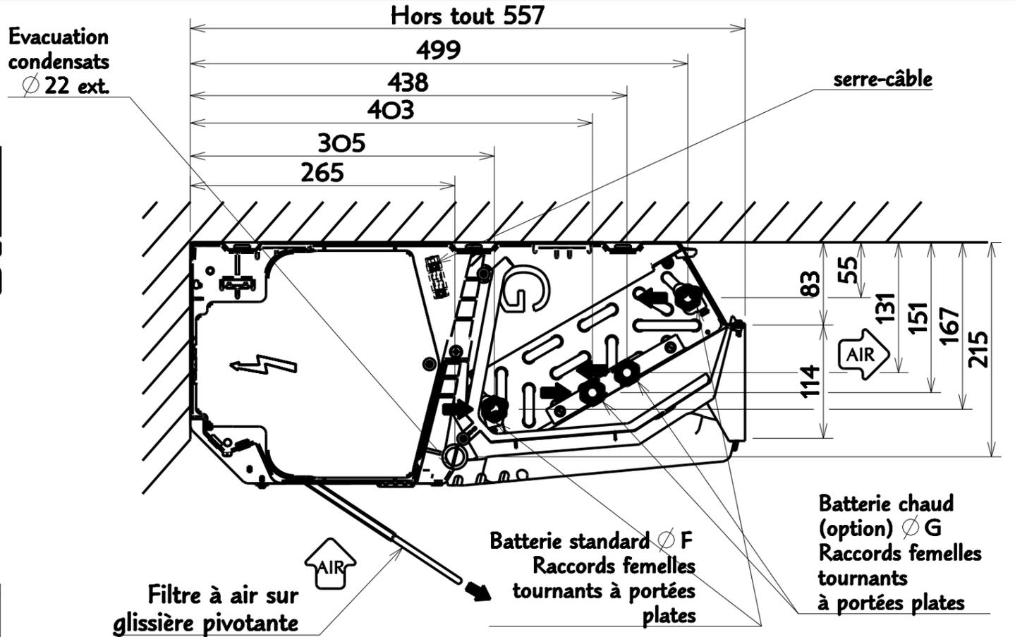
Raccordements hydrauliques représentés pour batteries 2T ou 4TX . Pour batteries 4TY , voir folio 5
