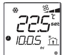
La pantalla PH17 (grupo 05. Prog. horaria) del terminal VectiGD permite ver si programación horaria del terminal TCO está activada, la banda actual y la consigna de temperatura.
