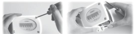
Para configurar el equipo, desconéctelo de la corriente, proceda a los ajustes deseados colocando los interruptores como se indica en las tablas. Una vez configurado el captador, conéctelo a la corriente
